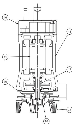
11 Albero con rotore – Pump shaft + rotor
