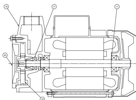
**11** Albero con rotore – Pump shaft + rotor
